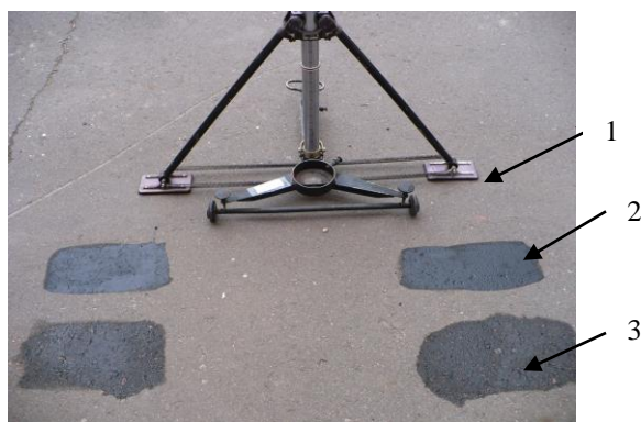
Рисунок 4 – Проведение испытания на приборе ППК 1 – чистый асфальт, 2 – обработка гидрофобной композицией, 3 – обработка клеевым составом
