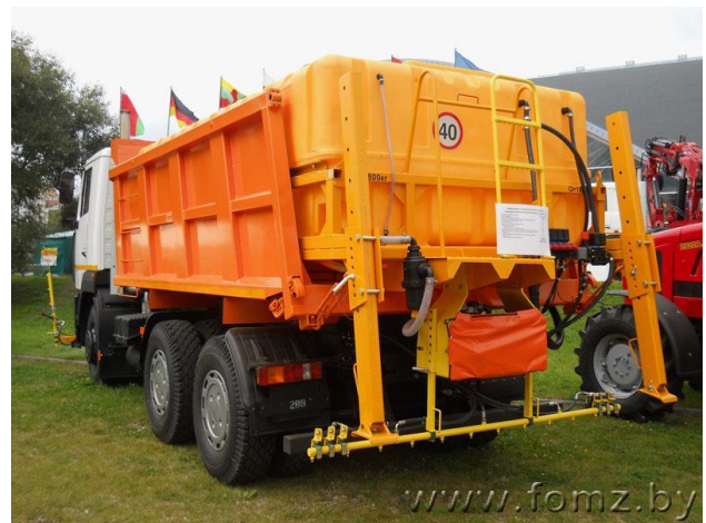
Рисунок 1 - Оборудование высокого давления с распределителем жидких материалов OPC-37 на базе автомобиля МАЗ-6501
