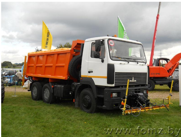
Рисунок 1 - Оборудование высокого давления с распределителем жидких материалов OPC-37 на базе автомобиля МАЗ-6501
